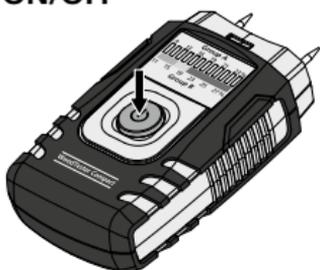
El aparato se desconecta automáticamente a los 3 minutos para proteger las pilas. Para encender de nuevo el aparato pulse otra vez el interruptor On/Off.
